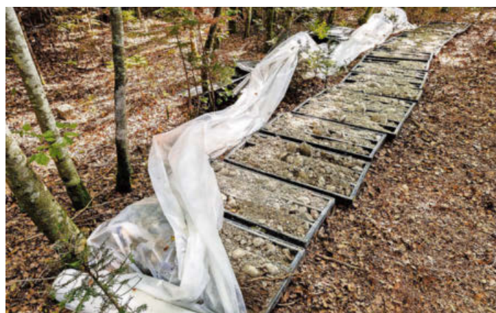
Der Bohrkern wird neben der Baustelle sauberlich Meter für Meter ausgelegt. So ist das Gestein auf einen Blick erkennbar.
