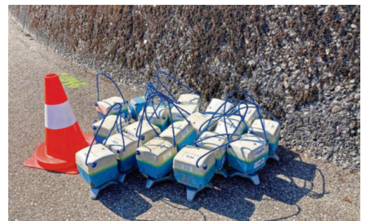
Die Messungen an der Wetziker Quartierstrasse sind beendet, die Geophone werden eingesammelt.
